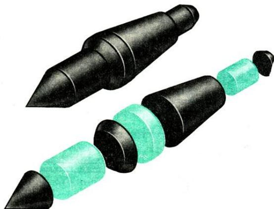
Рисунок 44 - Анализ формы центра токарного станка
